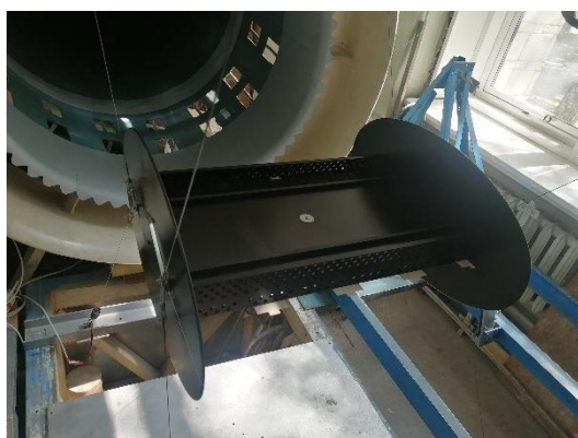
Рисунок 3.3 – Фотография и схема стенда с секционной моделью, закрепленной на упругих подвесках
