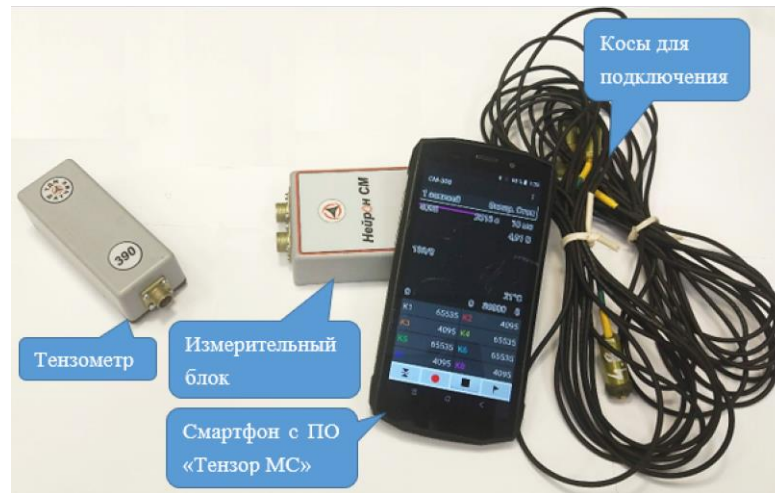
Рисунок 4.1 – Измерительное оборудование системы «Тензор МС»
