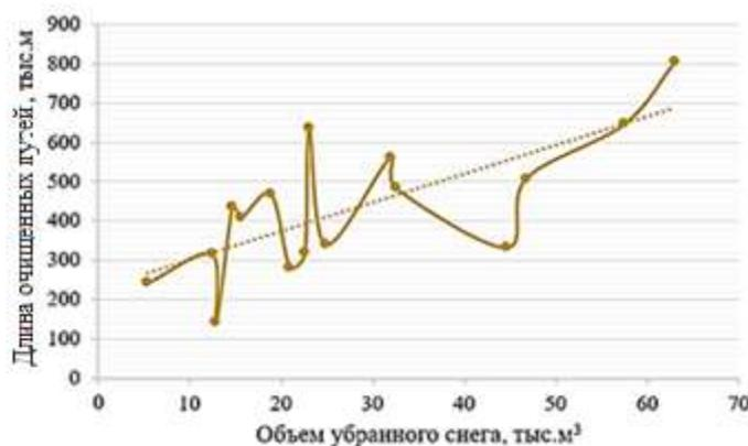
Рисунок 2.5 – График зависимости длины очищенных путей от объема убранного снега за 2019 - 2021 годы
