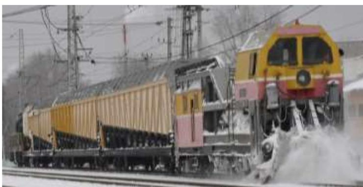
Рисунок 1.14 - Снегоуборочная машина типа СМ
