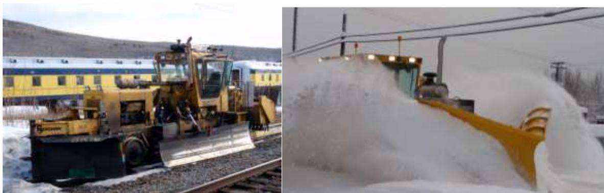
Рисунок 1.5 - Балластный регулятор
