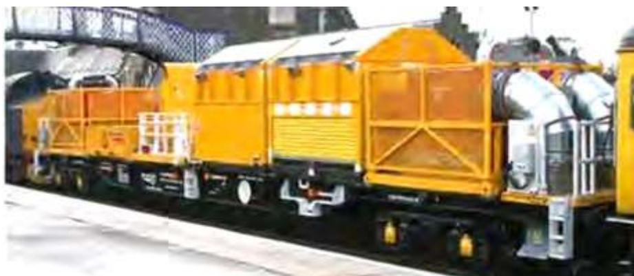
Рисунок 1.11 - Снегоуборочная машина Network Rail
