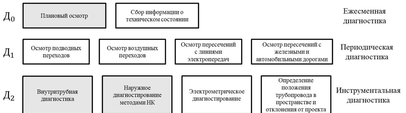
Рисунок 1.9 – Процесс технического обслуживания и ремонта
