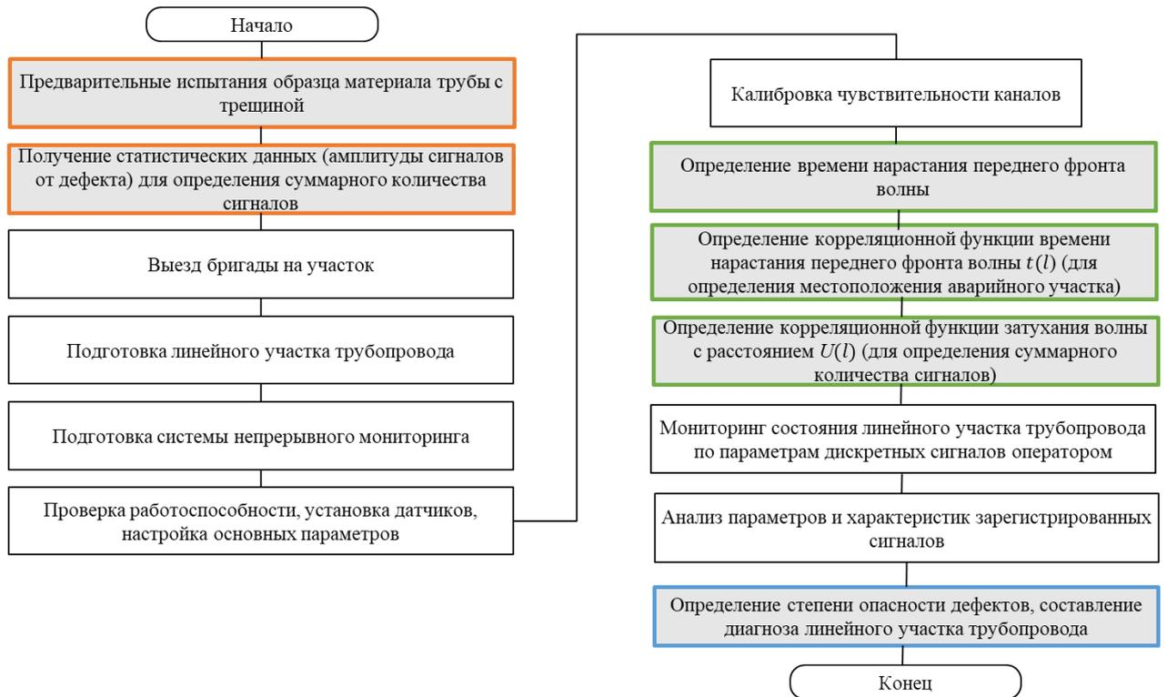
Рисунок 4.5 – Блок-схема алгоритма организации процесса непрерывного мониторинга линейного участка магистрального трубопровода
