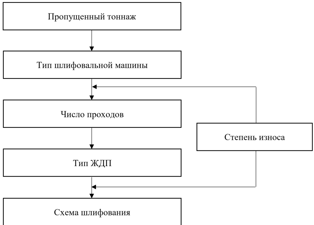
Рисунок 1.7 – Схема назначения удаления поверхностных дефектов
