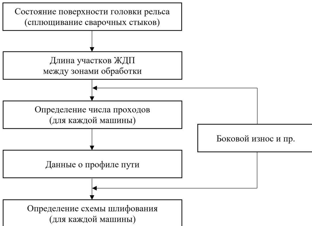
Рисунок 1.4 – Алгоритм определения числа проходов РШП и схемы шлифования
