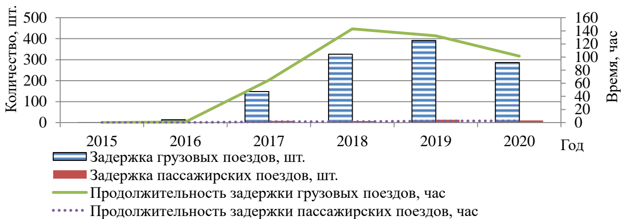
Рисунок 1.3 – Задержки поездов вследствие отказов 3-й категории
