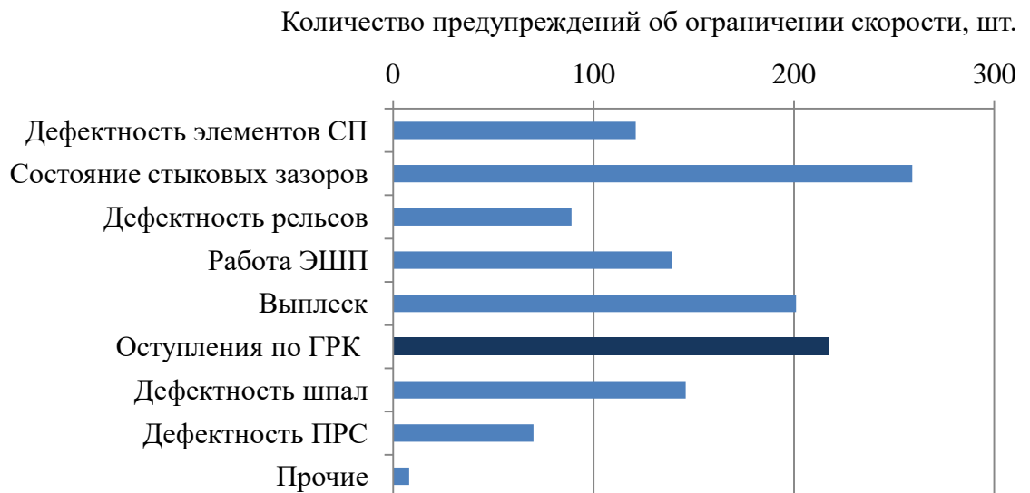
Рисунок 1.9 – Распределение основных причин ограничений скорости на участке Среднесибирского хода (Каменская дистанция пути) за период с 2015 по 2018 год
