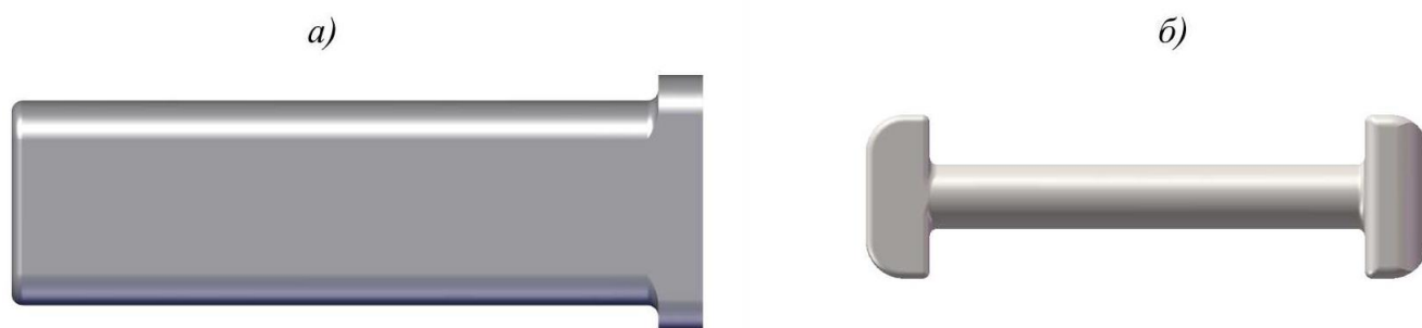
Рисунок 2.3 – Внешний вид деталей: клин тягового хомута (а) и маятниковая подвеска (б)
