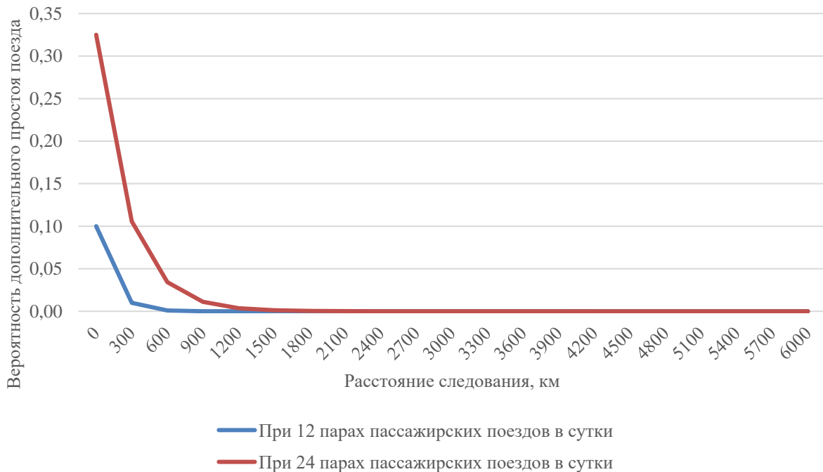
Рисунок 3.17 – График зависимости вероятности возникновения дополнительного простоя поезда на технической станции от расстояния следования
