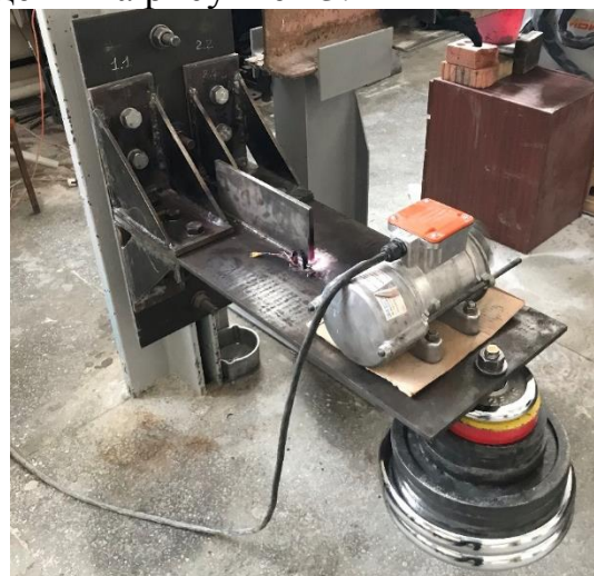
Рисунок 13 – Установка для усталостных испытаний образцов при изгибе: а – схема; б – фотография
