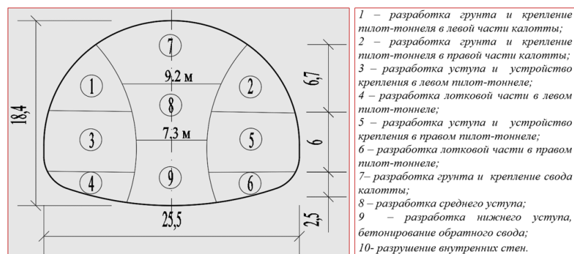
Рисунок 4.1 – Поперечное сечение выработки и порядок раскрытия опережающих забоев
