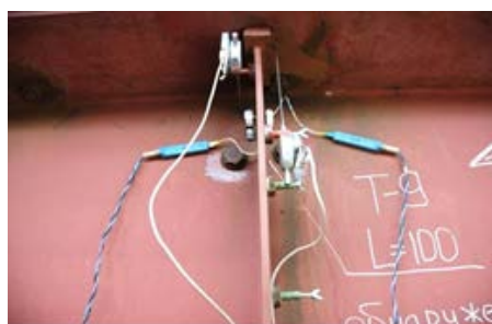
Рисунок 14 – Расстановка приборов до и после усиления:
