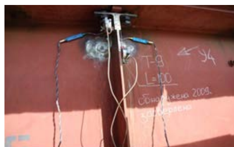
Рисунок 14 – Расстановка приборов до и после усиления:
