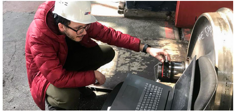
Контроль плотности посадки внутреннего кольца подшипника буксового узла на шейку оси колесной пары прибором УДС1-СИН
